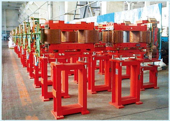
■ 为日本高能加速器机构 (KEK) 的J-PARC研制的校正磁铁
